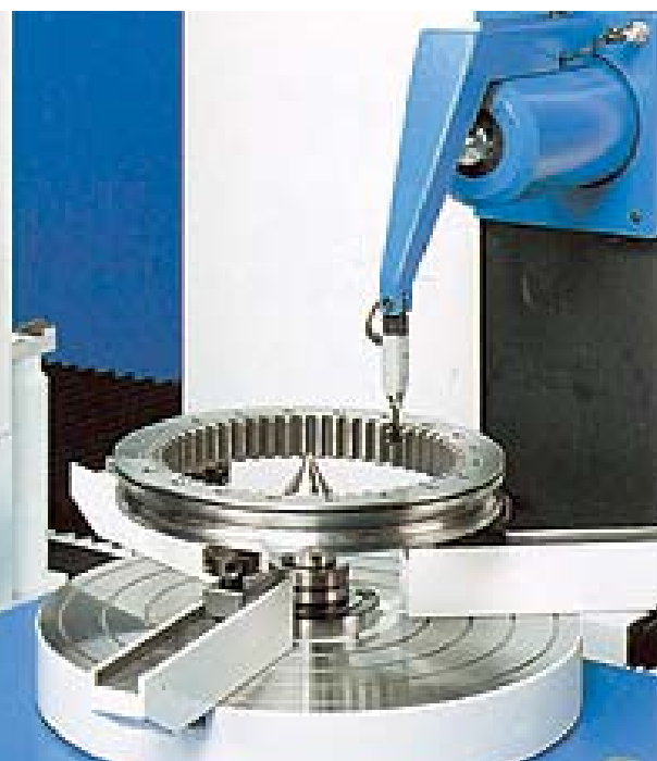
foto 2: Controllo dentatura interna su Anello per Riduzione epicicloidale
