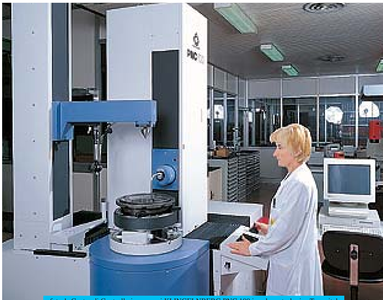
foto 1: Centro di Controllo ingranaggi KLINGELNBERG PNC 100 in sala metrologica Trasmital
